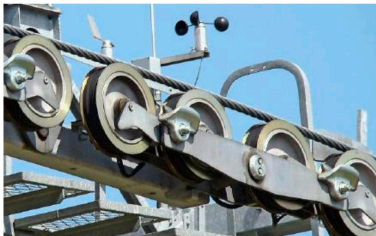
Die muldenförmigen Seilfänger - auf dem Verbindungsstück der Rollen - sollen bei einer Entgleisung den Absturz des Seils verhindern. Foto: Xpicto
